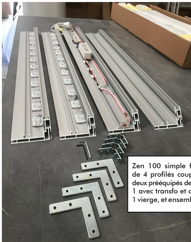
Zen 100 simple face composé de 4 profilés coupe à 45° dont deux prééquipés des modules led, 1 avec transfo et connectique, 1 vierge, et ensemble d'équerres
